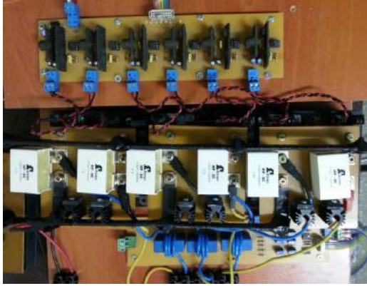
Şekil 14. Üç-fazlı bir klasik LARM sürme devresi
