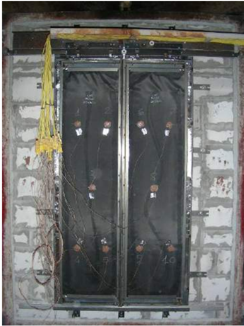
Resim 1 - Thermocoupleların kapı üzerine yerleştirilmesi
